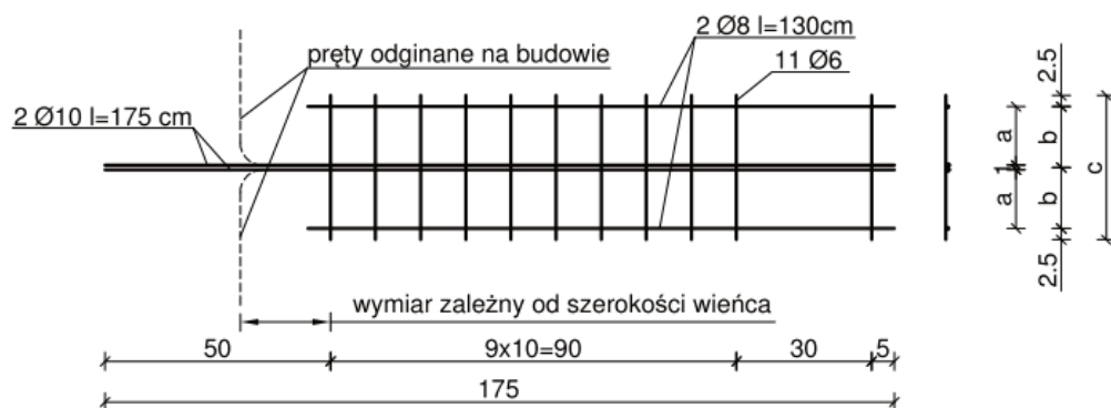
Rysunek 14. Siatka zagięta zbrojenia podporowego Z-1 dla stropów o rozpiętościach powyżej 6,00m
